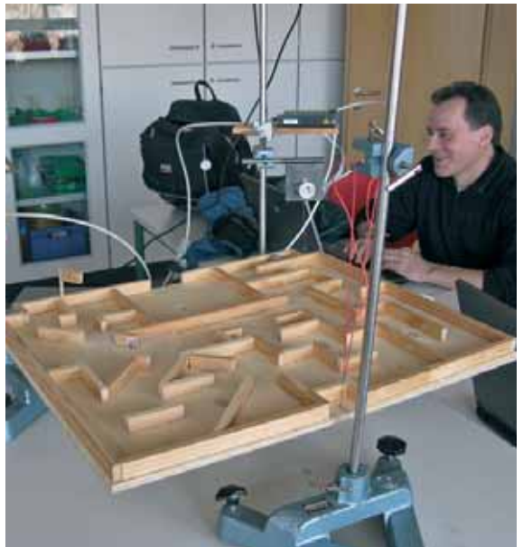
Mithilfe eines Kugelspiels wurde die Programmierung der Antriebe erprobt
